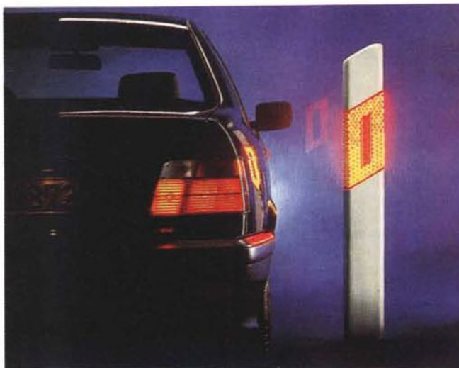
Fig. 4: Il sistema Automatic Emergency Call di BMW è basato sui catarifrangenti elettronici, ovvero i link dei veicoli con l'infrastruttura di rete, posti ai margini dell'autostrada e connessi con dei concentratori, a loro volta collegati con i centri di gestione del traffico.
